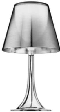
Tischleuchte für diffuses Licht. Gesamter Leuchtenkörper aus transparentem, spritzgegossenem PMMA (Polymethylmethacrylat); interner Diffusor aus opalem, spritzgegossenem PC (Polykarbonat); äußerer Diffusor aus spritzgegossenem PC (Polykarbonat); dessen Innenfläche mittels eines besonderen Vakuumverfahrens aluminiumbeschichtet ist.
